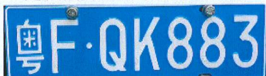
图 19 定位裁剪后的车牌彩色图像
